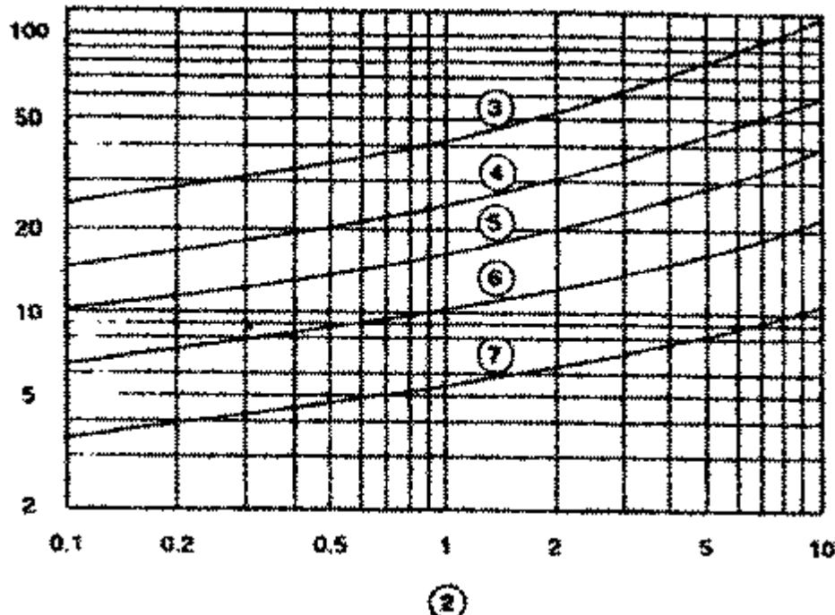
Зависимост между оразмерителната стойност на грапавината  $k_2$  и загубите на налягане при различни вътрешни диаметри  $D$  (при дължина на участък отводопровода 100 m, скорост на водата 1,5 m/s и температура на водата 10 °C): 1 - загуби на налягане, kPa; 2 - грапавина, m x 10 на степен  $-3$ ; 3 -  $D = 100$  mm; 4 -  $D = 150$  mm; 5 -  $D = 200$  mm; 6 -  $D = 300$  mm; 7 -  $D = 800$  mm.
